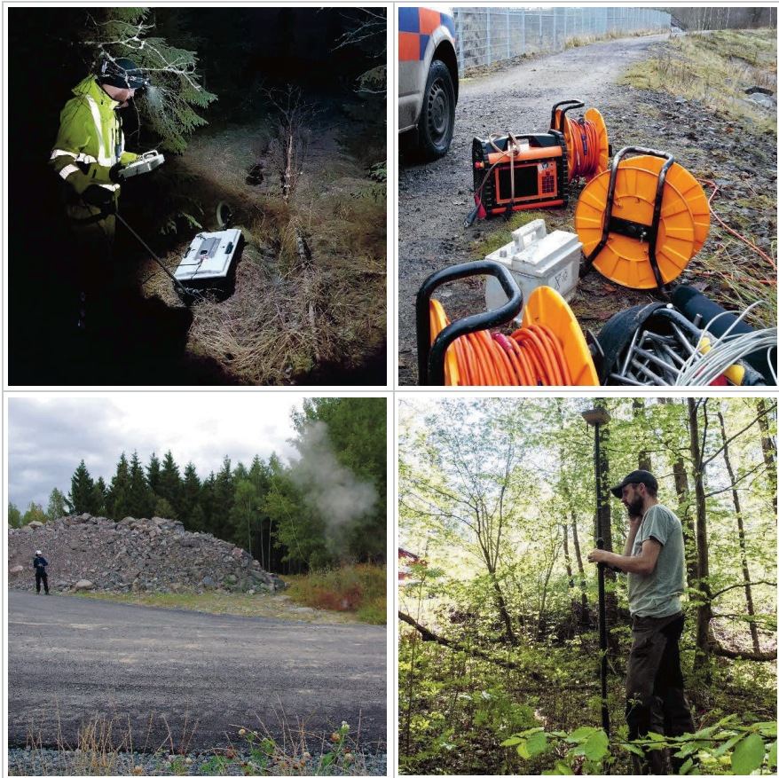
Figur 1. Överst T.V. – Georadarutrustning i, för borrhbandvagn, otillgängligt område, överst T.H - Resistivitetsutrustning med mätkablar och elektroder, underst T.V. - Detonation av ca 30 g dynamit vid refraktionsseismisk mätning och underst T.H. -Inmätning av geofysisk mätlinje med RTK-GPS.
